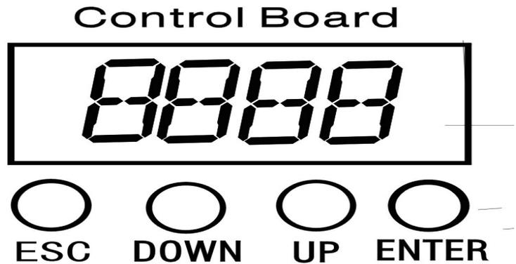
**Menü 1:** A001 ist die DMX Adresse. Drücken Sie Enter, um die Adresse zu editieren. Drücken Sie die Tasten „Down“ oder „Up“, um eine Adresse zu auswählen. Um zu speichern, drücken Sie die Taste „Enter“. Das Display blinkt, wenn kein Signal anliegt.
